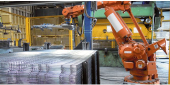
02. Automazione piegatura rete
